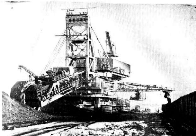
Рис. 2.16. Роторный экскаватор ЭРП-2500
