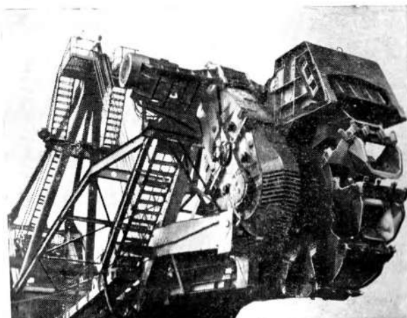
Рис. 2.13. Центробежное роторное колесо экскаватора ЭР-1250
