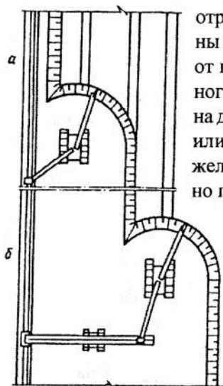
Рис. 38. Схема отработки торцового забоя валово-раздельным способом: а - с выгрузкой разделенного потока на два забойных конвейера (два железнодорожных пути); б - с выгрузкой потока на двухниточный конвейерный перегружатель.
