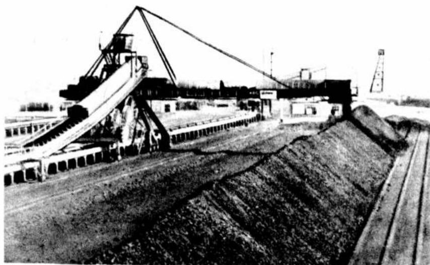
Штабелеукладчик фирмы "Везерхютте" на разрезе "Восточный"
